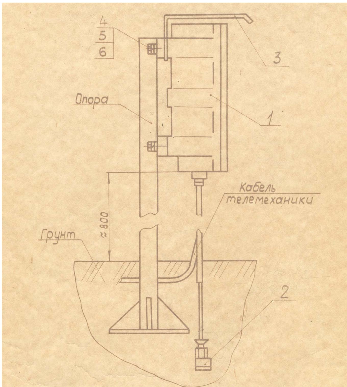
1-преобразователь, 2-зонд, 3- козырек; 4- болт М6×16 (4шт.);
