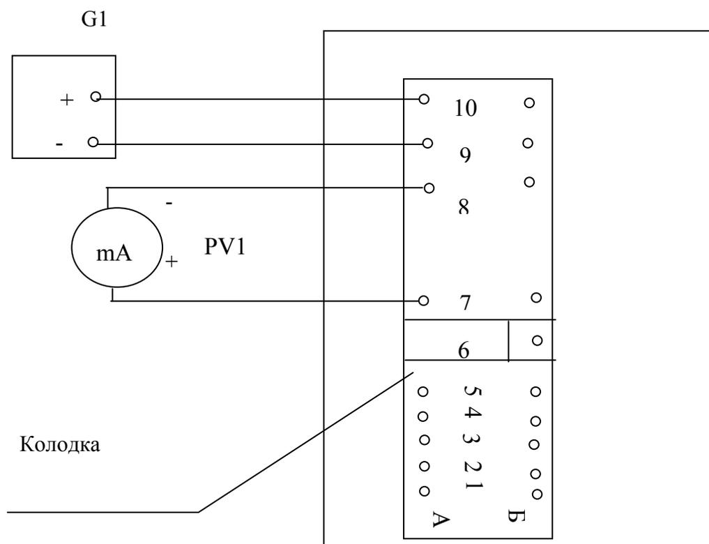
А –поверяемый датчик температуры
