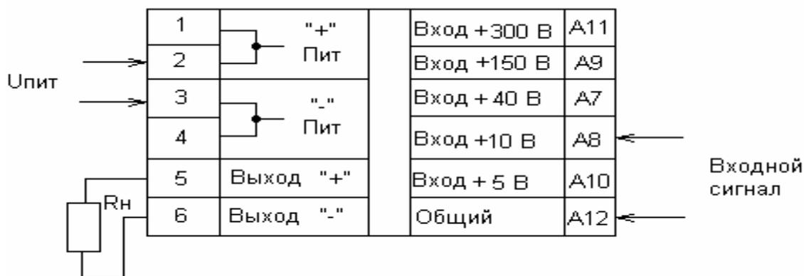
Рисунок 1.3 - Схема подключения к ПИ при измерении входного сигнала от 0 до 10 В
