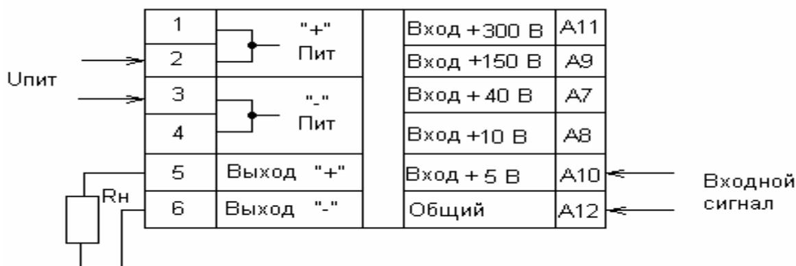
Рисунок 1.2 – Схема подключения к ПИ при измерении входного сигнала от 0 до 5 В
