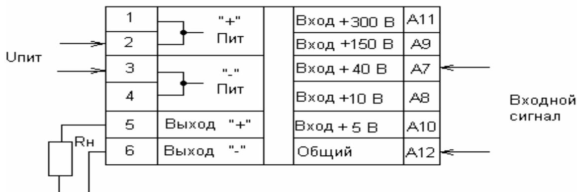
Рисунок 1.4 - Схема подключения к ПИ при измерении входного сигнала от 0 до 40 В
