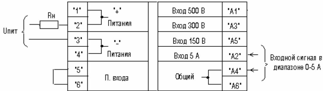
Примечание - Перемычка между клеммами "5" и "6" устанавливается только при измерении входного сигнала в диапазоне  $I_{вх}$  0-5 А.
